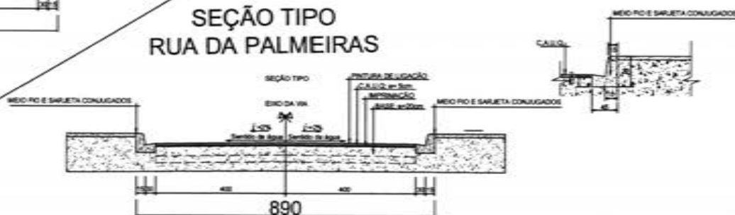
SEÇÃO TIPO - PAVIMENTAÇÃO ASFALTICA TRECHO FINAL ESCALA: 5/1
